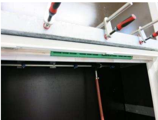
Bild 22 Falzlüfter in eingebautem Zustand, Variante 4 DOUBLE acoustic
