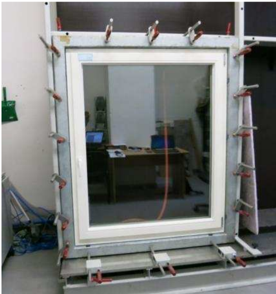
Bild 1 Probekörperansicht auf Prüfstand Fenster geschlossen
