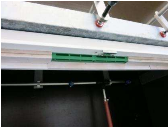
Bild 18 Falzlüfter in eingebautem Zustand, Variante 2 SINGLE acoustic
