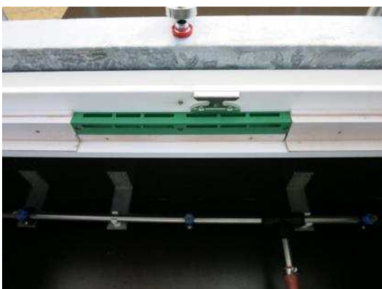
Bild 16 Falzlüfter in eingebautem Zustand, Variante 1 SINGLE
